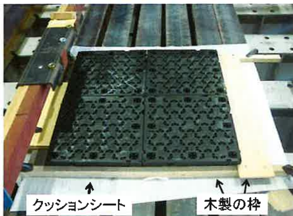
試験状況, 仕上材なし(試験体2)
