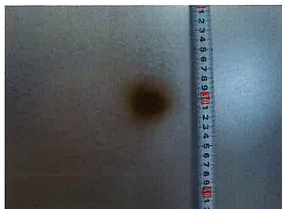
試験後の試験体背面の状況
