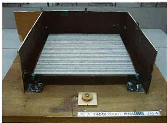
試験体設置状況
