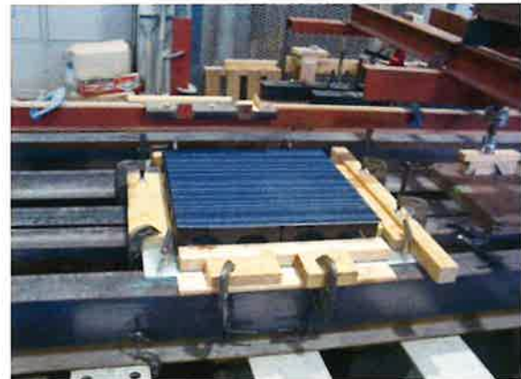
試験状況(加撃前), 仕上材あり(試験体2)
