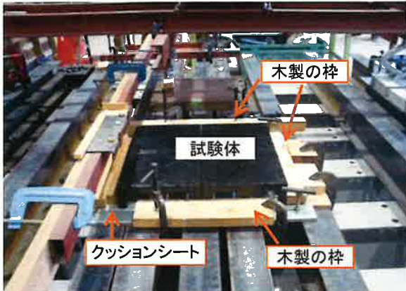
試験状況(加撃前), 仕上材なし(試験体1)
