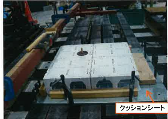
試験状況(加撃前), 仕上材なし(試験体1)
