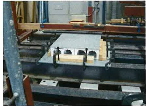
試験状況(加撃前), 仕上材あり(試験体1)
