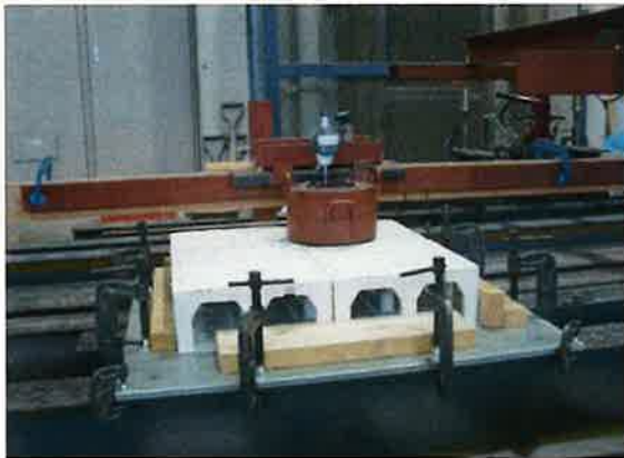
試験状況(加撃前), 仕上材なし(試験体1)
