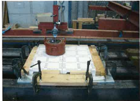
試験状況(加撃前), 仕上材なし(試験体3)
