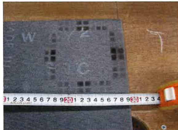
試験後の仕上材(タイルカーペット)裏面の状況 燃焼の熱によって一部変化した
