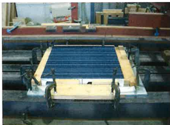
試験状況(加撃前), 仕上材あり(試験体3)
